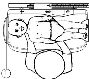
1. Τοποθετείτε το βρέφος στο κοίλωμα της ζυγαριάς. Το κεφάλι του βρέφους πρέπει να εφάπτεται στο σημείο αναστολής (1) του κοίλωματος.
